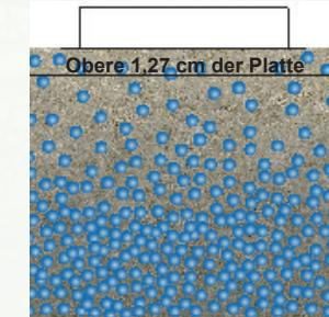
Calciumchlorid ist daher nur ein Oberflächentest, der stark von den Umgebungsbedingungen im Raum oder Gebäude beeinflusst wird. Selbst wenn er korrekt durchgeführt wird, sagt ein Calciumchlorid-Test nichts darüber aus, was in der Tiefe der Platte vor sich geht.
