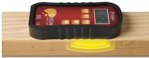
O campo do sensor de 2,0 polegadas (50mm) de largura por 2,5 polegadas (63mm) de comprimento por 0,75 polegadas (19mm) de espessura do medidor de umidade Orion® se aproxima do método de seção transversal de espessura total usado na execução do método de laboratório de secagem
