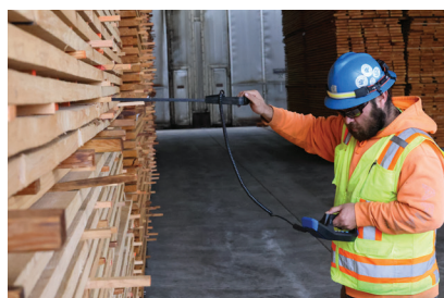
LE L5300 ASSOCIÉ À LA SONDE DE PILE L722 PÉNÈTRE EN PROFONDEUR DANS LES PILES DE BOIS POUR DÉTECTER L'HUMIDITÉ CACHÉE
