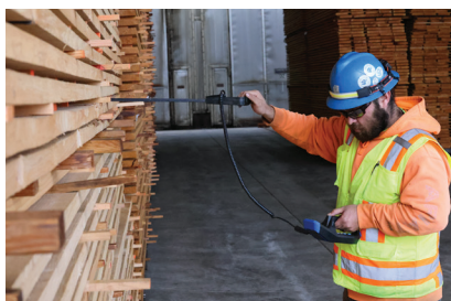
L5300 YHDISTETTYNÄ L722-PINOANTURI- IN TYÖNTYY SYVÄLLE PUUTAVARAPI- NOIHIN PILOSSA OLEVAN KOSTEUDEN MITTAAMISEKSI
