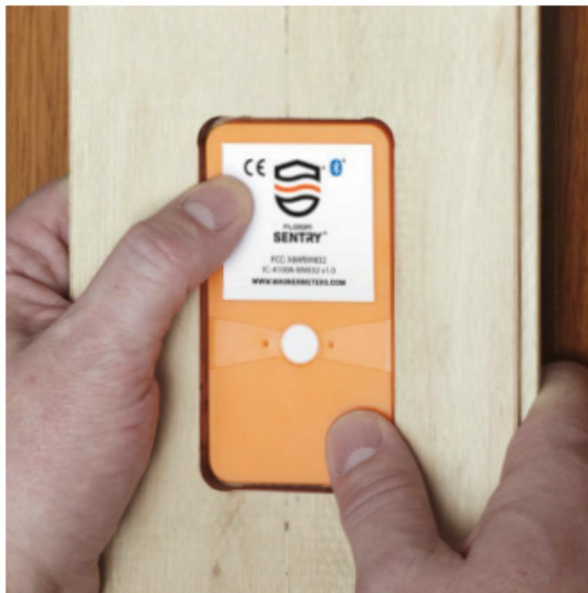
2. Butyldichtungsseite am Boden des Hohlraums befestigen. Achten Sie beim Einbau der Bodendiele in das restliche Bodensystem darauf, dass keine Klebstoffe oder andere bauliche Materialien die Unterseite des Floor Sentry beeinträchtigen. Denken Sie daran, dass jede Seite (sowohl oben als auch unten) des Floor Sentry einen Sensor enthält. Notieren Sie sich unbedingt den Installationsort des Floor Sentry, damit Sie ihn später wiederfinden können.
