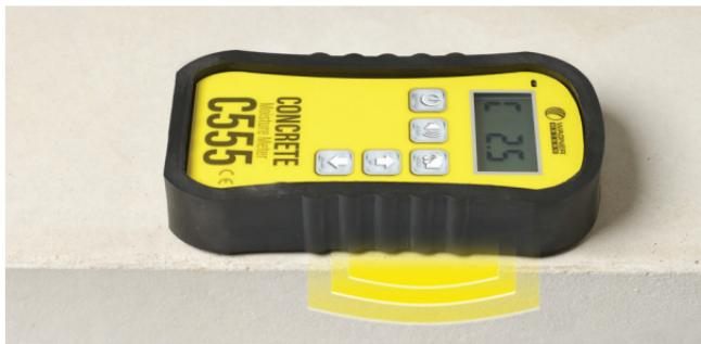
4. Certifique-se de pressionar para baixo com uma pressão leve, mas firme, para garantir um bom contato da placa do sensor com a superfície do concreto.
