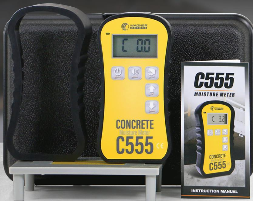
O medidor de umidade de concreto C555 fornece medições preliminares rápidas e não destrutivas de umidade em concreto liso e firme para ajudar a identificar áreas problemáticas e determinar onde colocar os sensores inteligentes RapidRH® L6.
